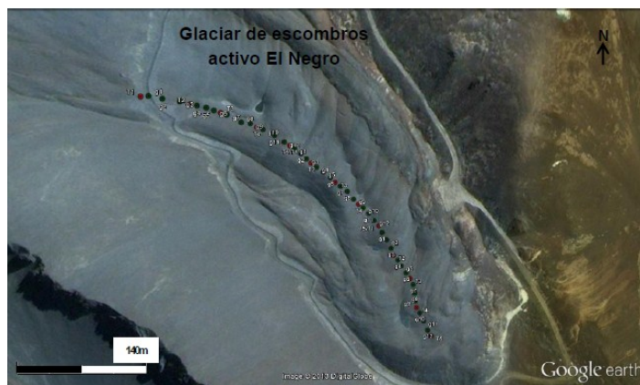
Figura N° 2: Ubicación de los 3 tendidos sísmicos en el glaciar de escombros activo El Negro. En rojo se observa la posición de los 5 tiros y en verde la posición de los 12 geófonos por cada tendido. El punto central de la imagen posee coordenadas de Latitud 31,7475 sur y Longitud 70,4543 oeste.
