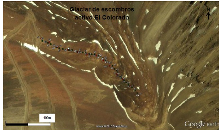
Figura N° 1: Ubicación de los 3 tendidos sísmicos en el glaciar de escombros activo El Colorado. En rojo se observa la posición de los 5 tiros y en verde la posición de los 12 geófonos por cada tendido. El punto central de la imagen posee coordenadas de Latitud 31,7435 sur y Longitud 70,4209 oeste.
